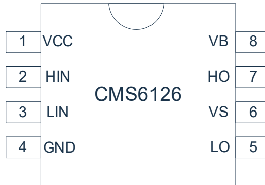
图 2-1 CMS6126 引脚示意
