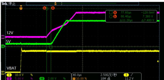
VBAT=VKEY=21V, 12V 带载 60mA 图 9-27 VBAT 上电 12V 输出
