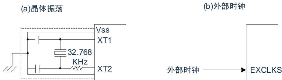
图4-13 XT1振荡电路的外接电路例子
