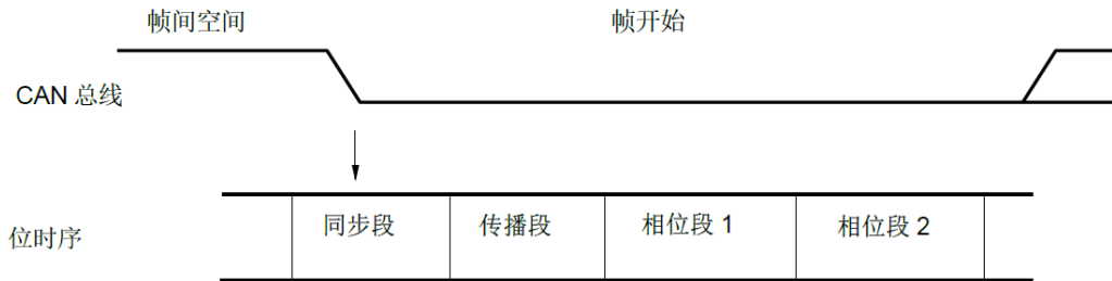
图21-20. 总线空闲期间在识别显性位时的硬同步
