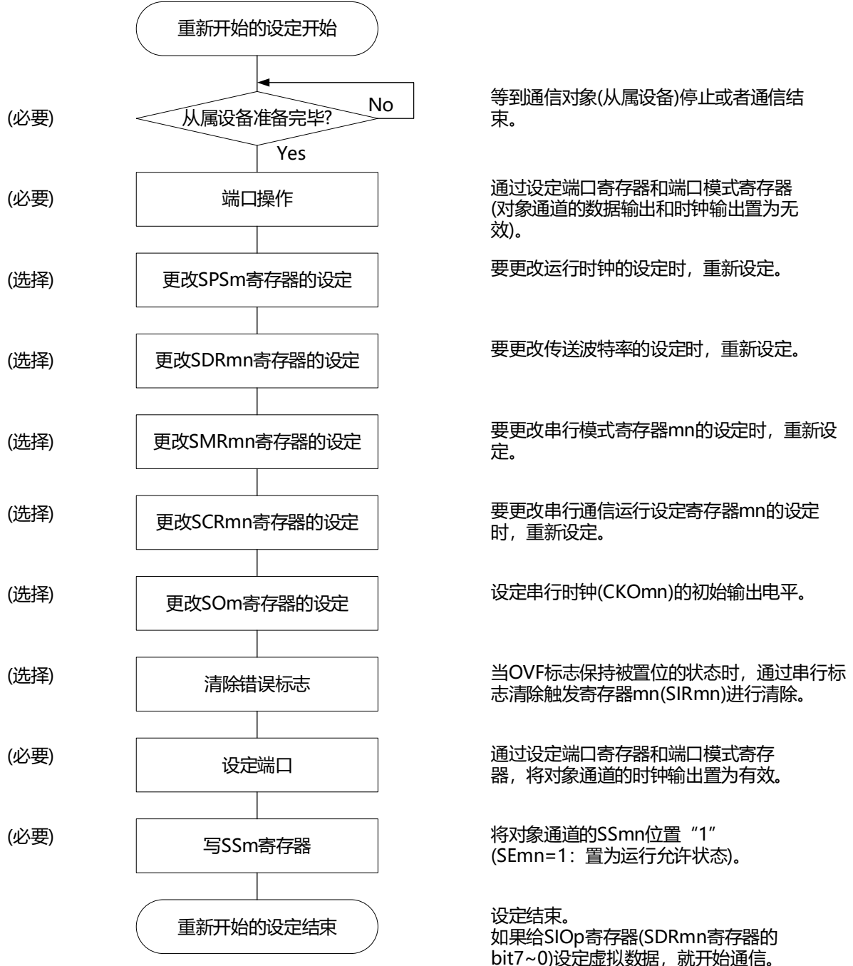
图19-36 重新开始主控接收的设置步骤
