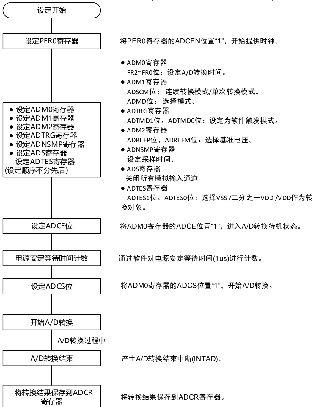
图15-34 测试模式的设置(VSS/half_VDD/VDD作为转换对象)
