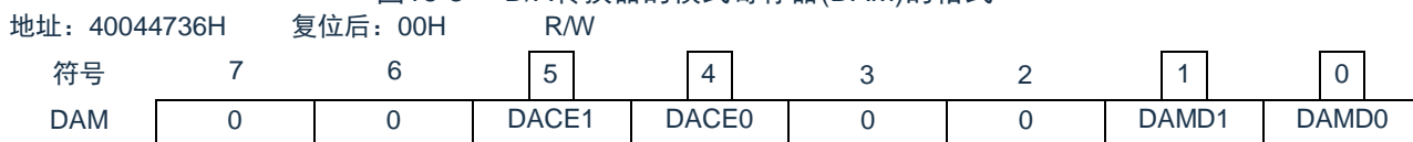
图16-3 D/A转换器的模式寄存器(DAM)的格式
