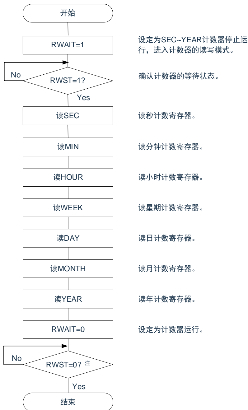
图11-19 实时时钟计数器的读操作步骤
