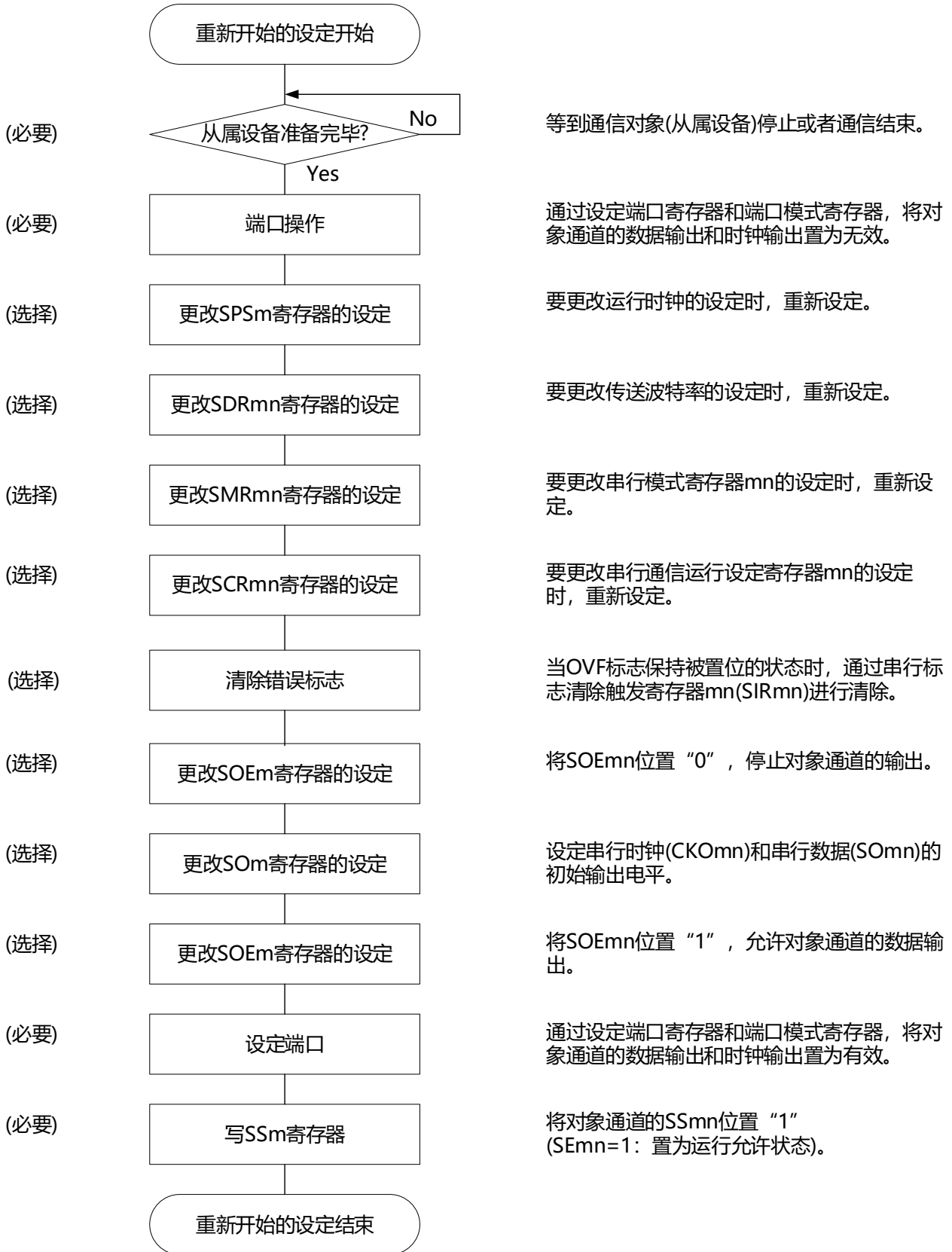
图19-44 重新开始主控发送和接收的设置步骤
