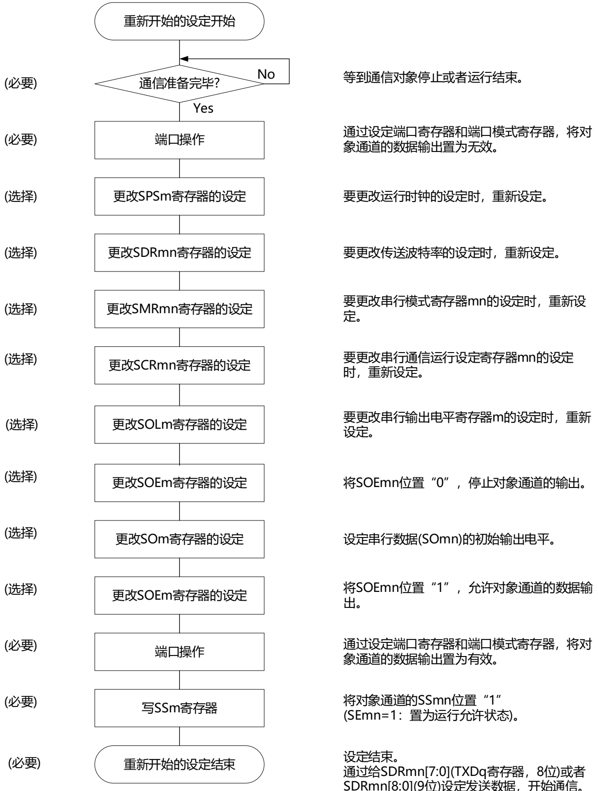
图19-104 重新开始UART发送的设置步骤
