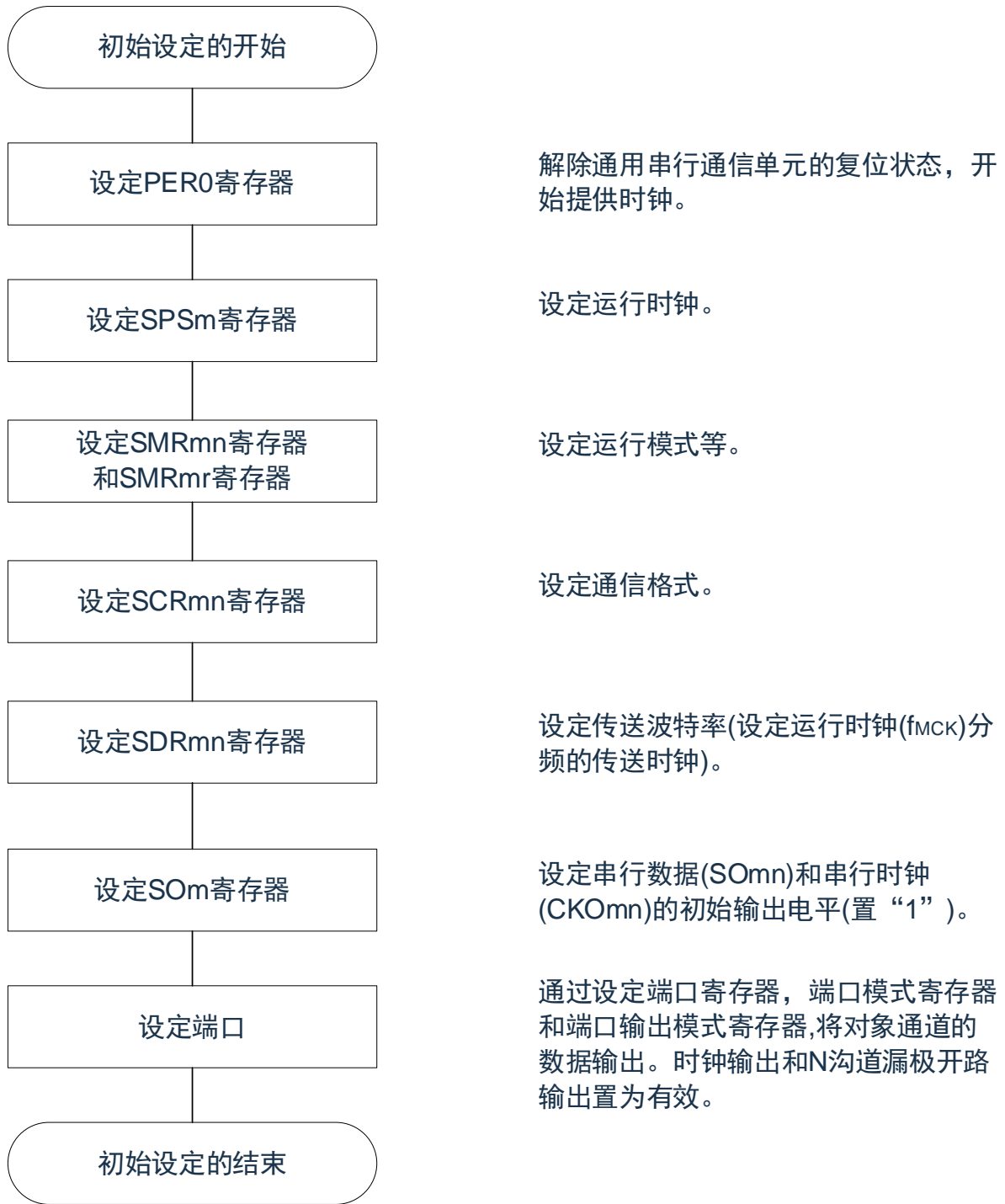
图19-129 地址段发送的初始设置步骤
