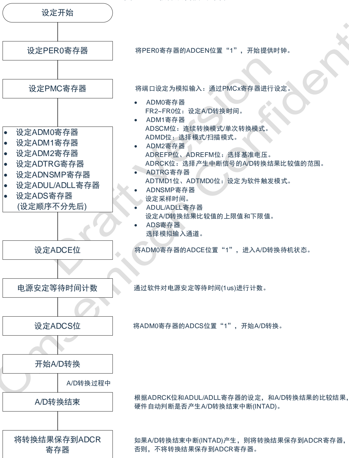
图13-31 软件触发模式的设置
