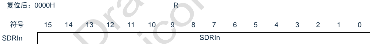
图19-6 接收缓冲寄存器 (SDR1n) 的格式
