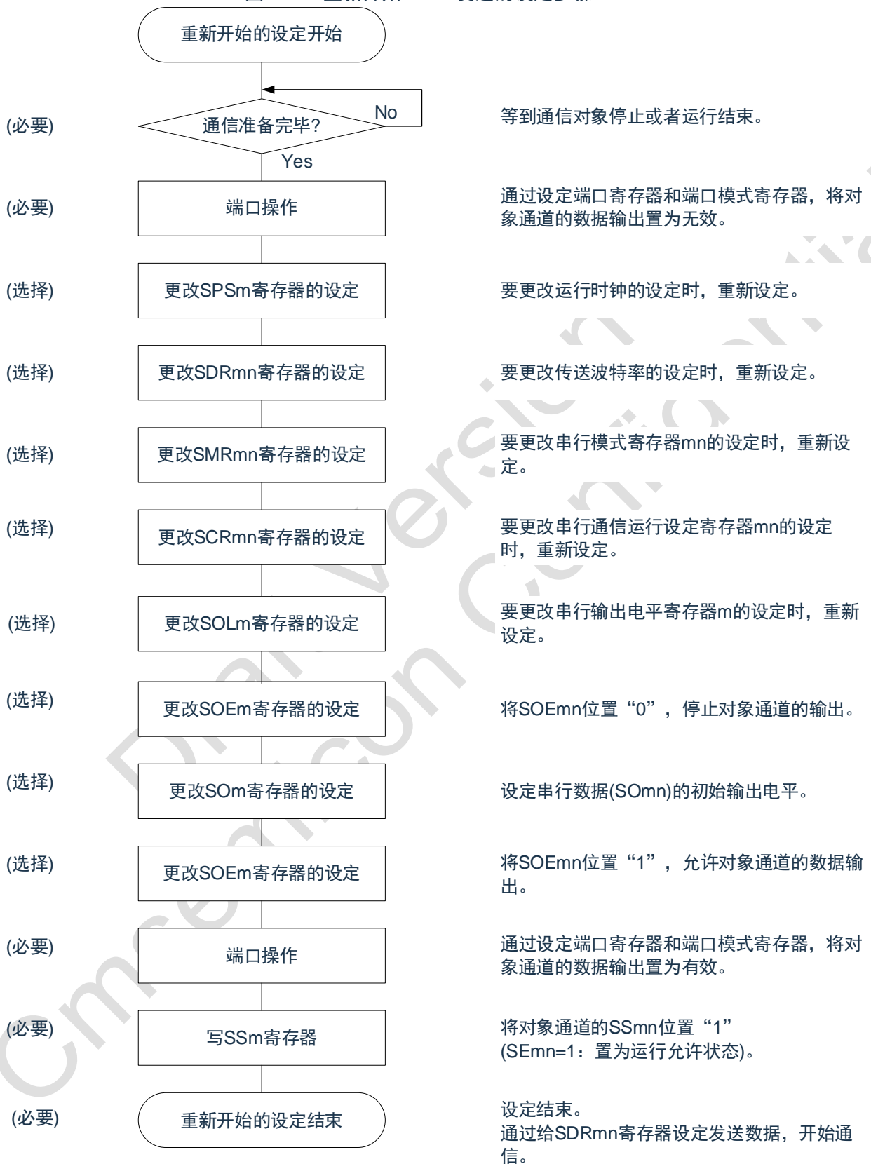
图17-99 重新开始UART发送的设定步骤
