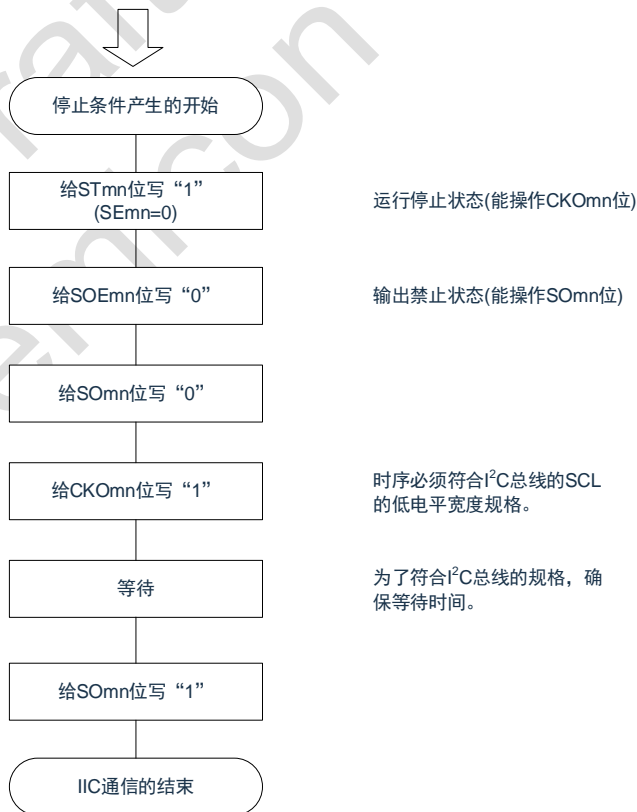
图17-135 产生停止条件的流程图
