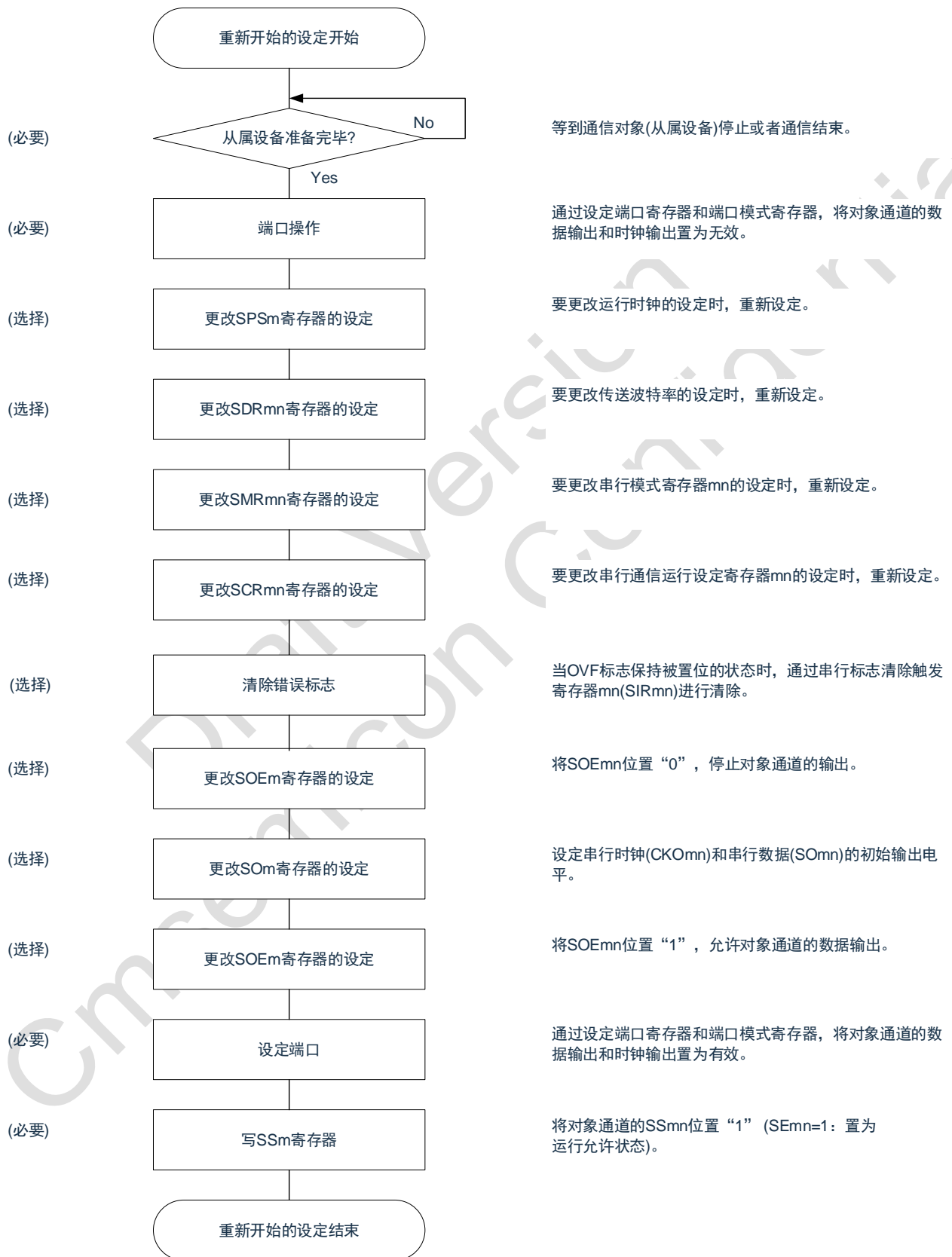
图17-42 重新开始主控发送和接收的设定步骤
