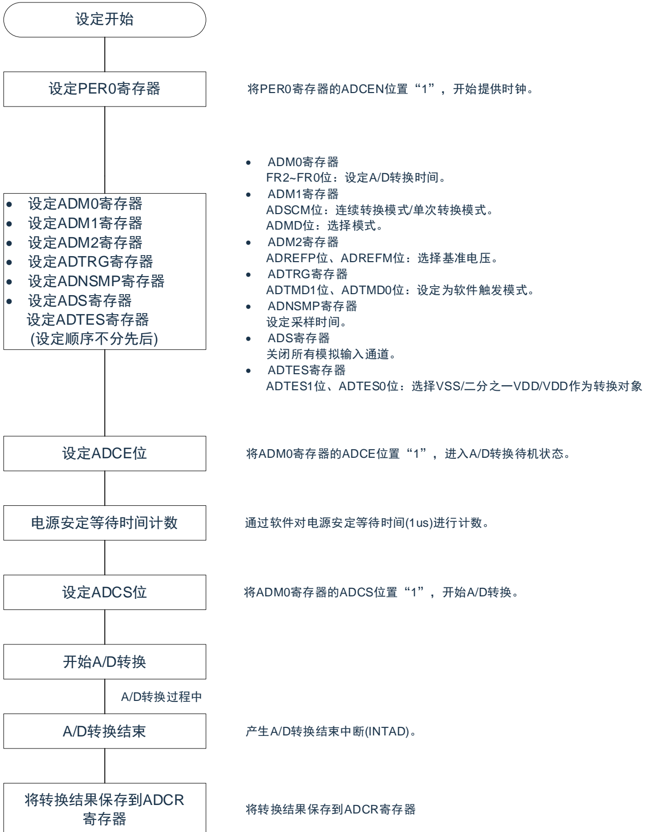
图15-36：测试模式的设置(VSS/half_VDD/VDD作为转换对象)
