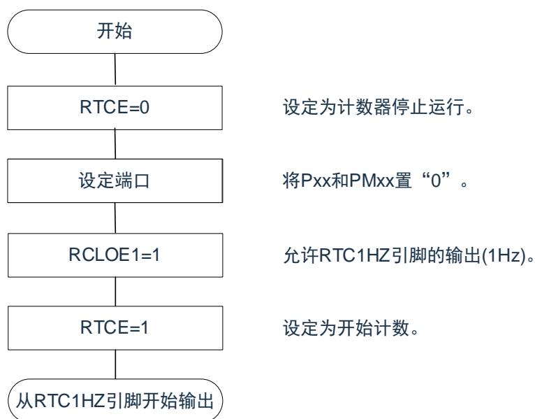
图11-22: 1Hz输出的设置步骤
