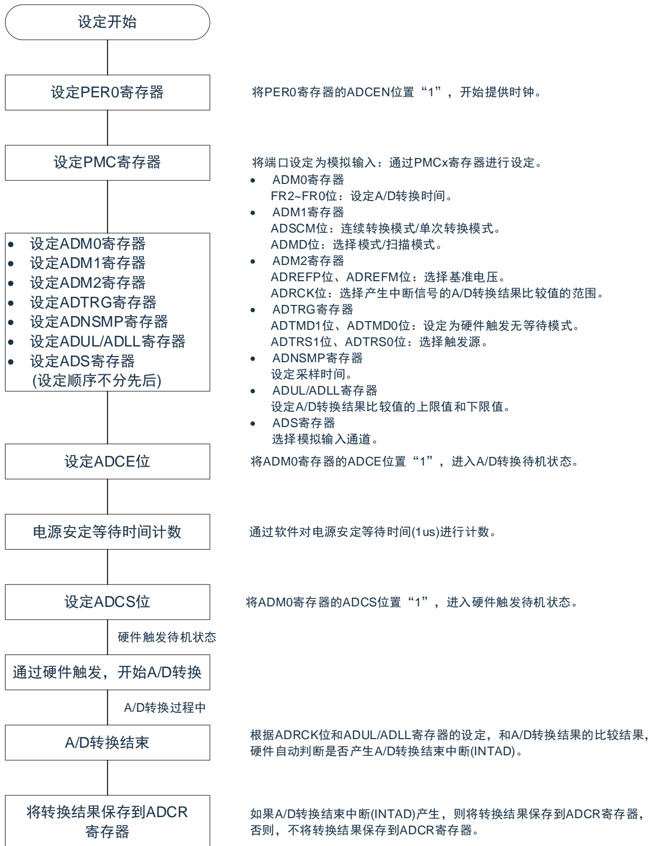
图15-33: 硬件触发无等待模式的设置
