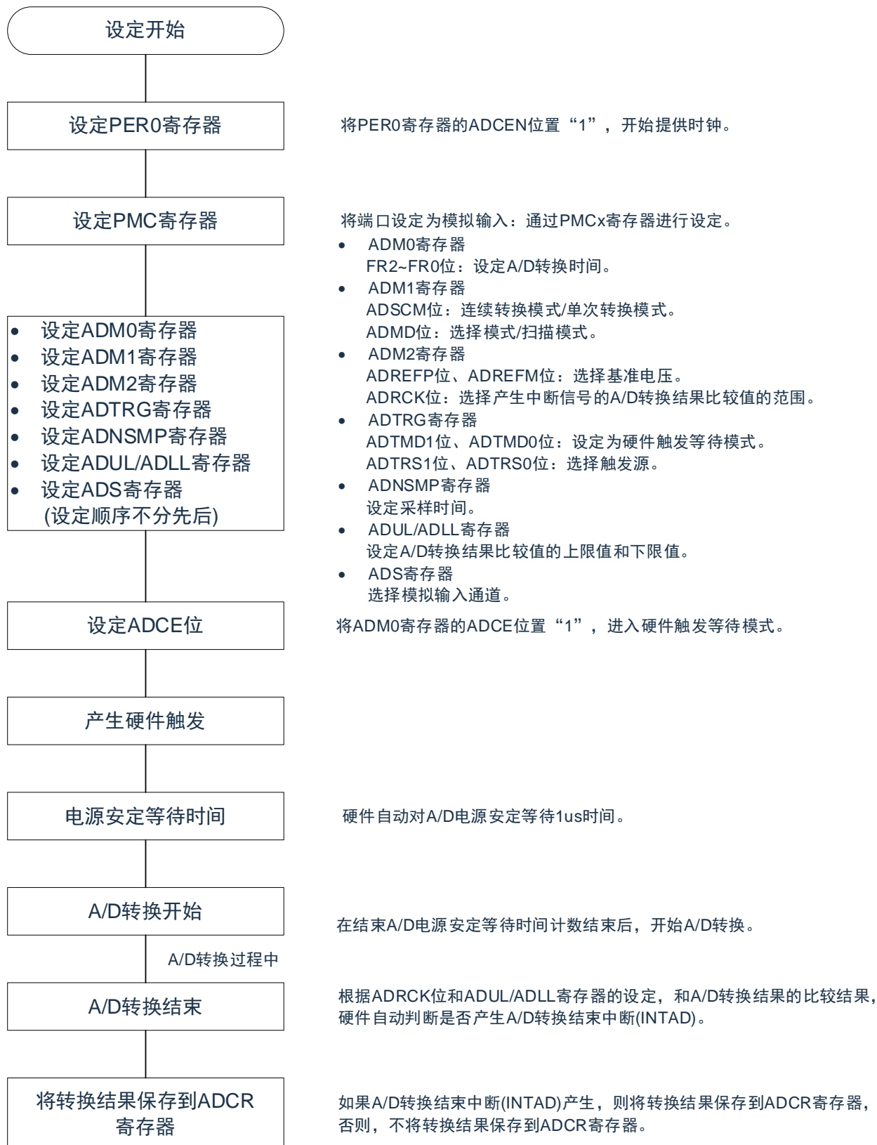
图15-34：硬件触发等待模式的设置
