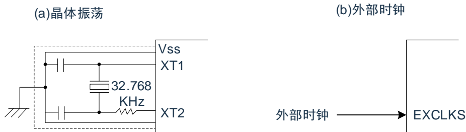
图4-13: XT1振荡电路的外接电路例子
