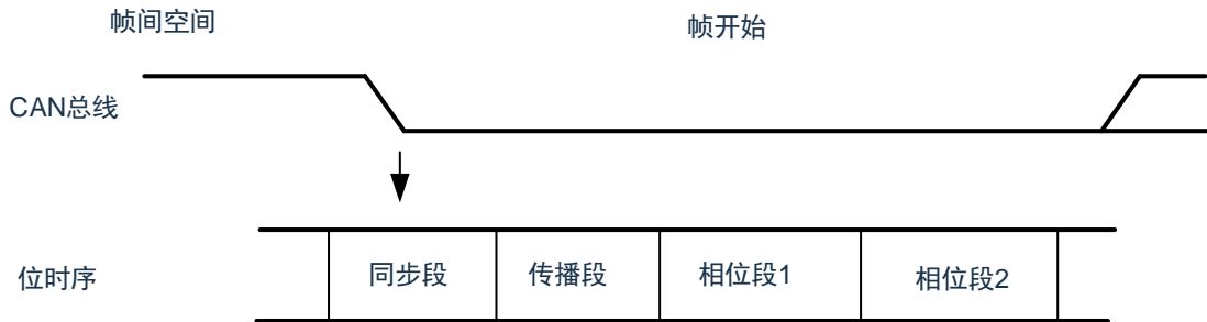
图21-20：总线空闲期间在识别显性位时的硬同步
