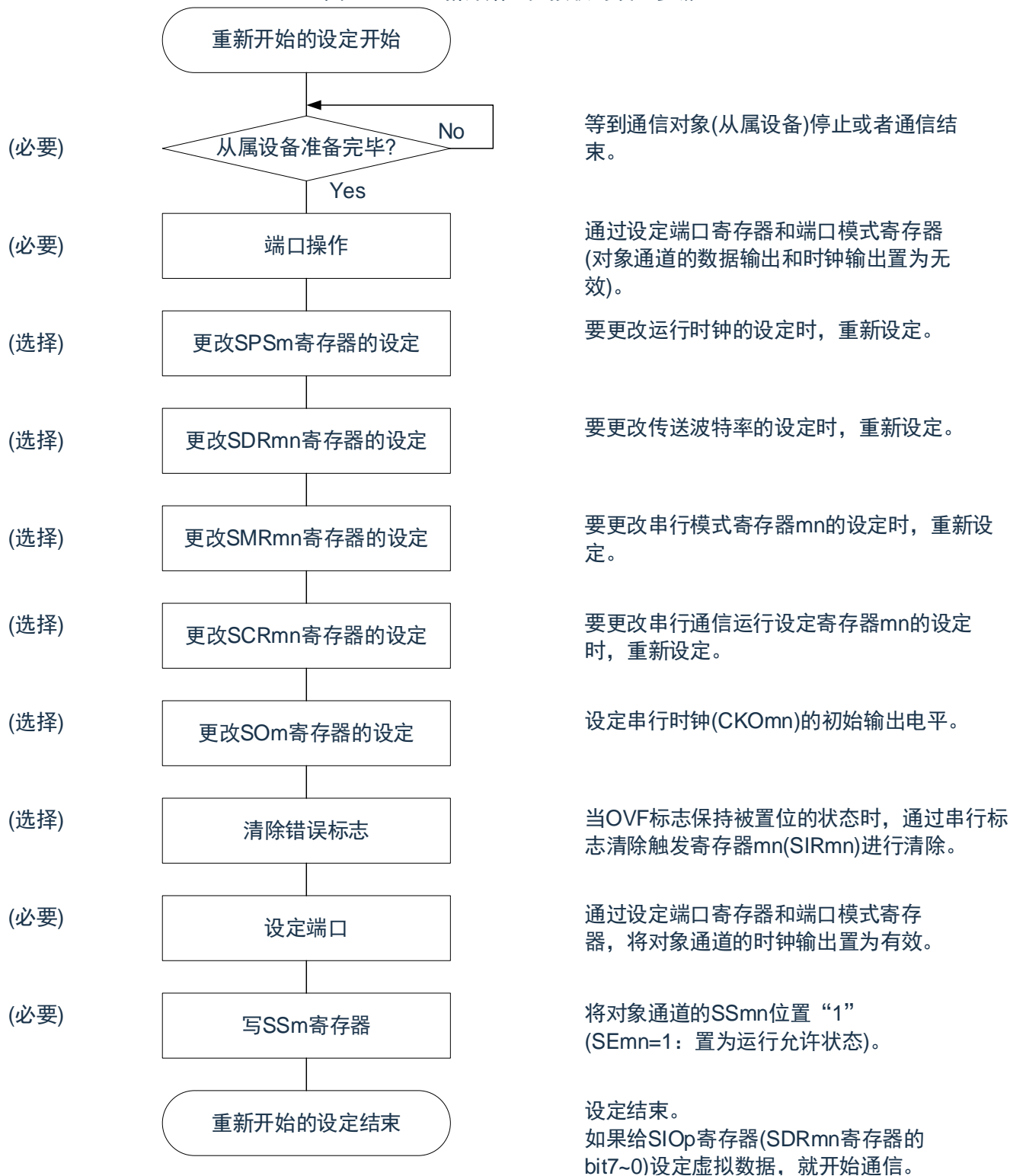
图19-34：重新开始主控接收的设置步骤
