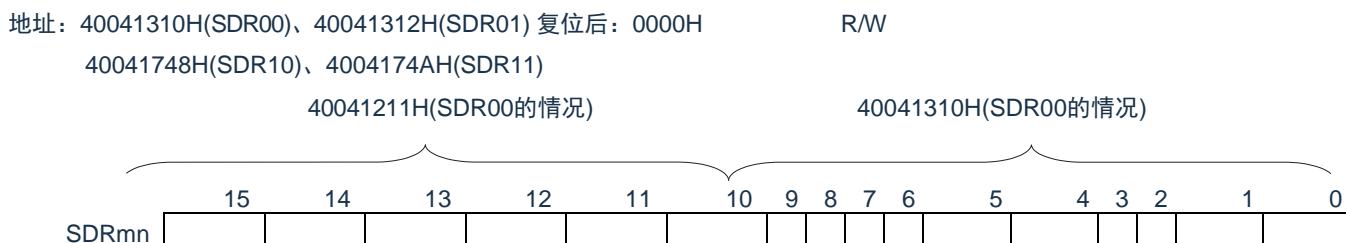
图19-9：串行数据寄存器mn(SDRmn)的格式
